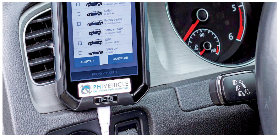
Phivehicle mide la potencia del motor y es una herramienta económica y sencilla.
