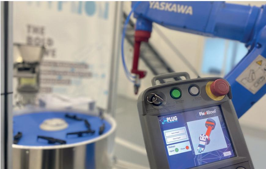
tengan la posibilidad de ser automatizados". Desde que el proyecto fue seleccionado por BFA se realizaron ya las primeras pruebas exitosas para establecer al robot como maestro, controlando los periféricos en un sistema de alimentación flexible con cámara, flexibowl, alimentador e iluminación por luz artificial.
